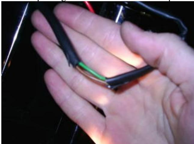
3- Placer la cosse voleuse sur le fil marron (+) puis placer le câble rouge des poignées dans la cosse (plutôt que de couper, j'ai choisi d'isoler la cosse ronde des poignées avec de l'adhésif électrique) et enfin fermer la cosse voleuse.
