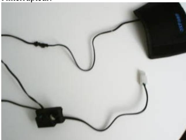
Le câble + fusible qui se branche sur la batterie ou sur la veilleuse par exemple:
